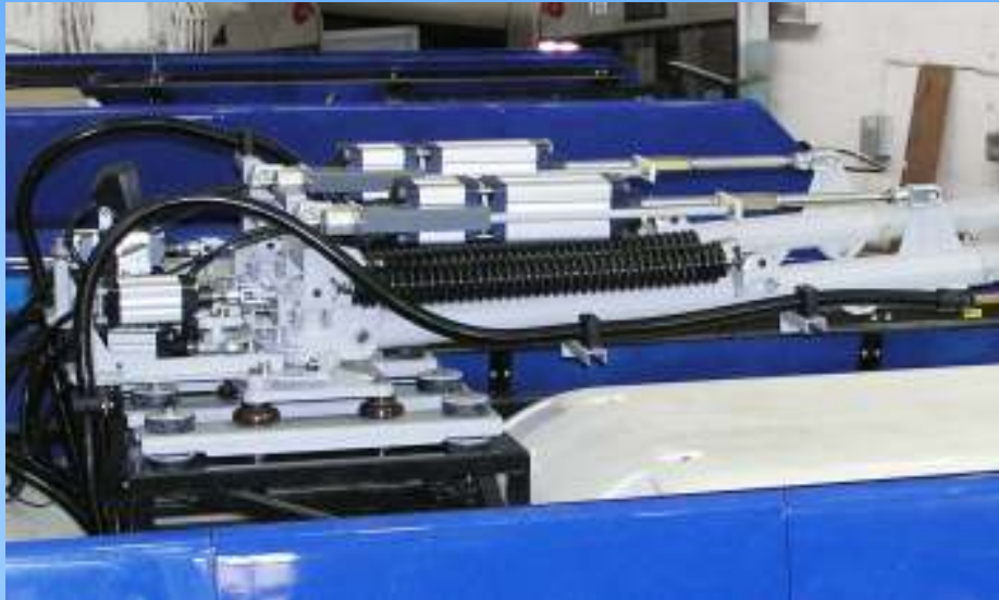
Rúdmozgató pneumatikus tandem munkahenger és mellette a szöghelyzet-jeladó
